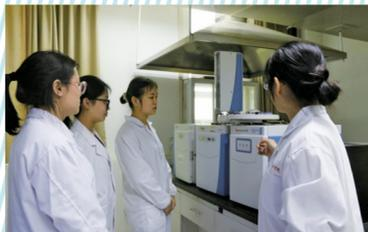
气相色谱-三重四级杆质谱联用仪(Gas chromatography-Mass spectrometry),是临沂大学在2017年12月以76.3万元购入型号为TSQ 8000Evo的运用于复杂组分的分离与鉴定的仪器。目前存放于科技大楼,由化学化工学院负责管理。液质联用仪体现了液相色谱和质谱的优势互补,将色谱对复杂样品的高分离能力,与质谱的高选择性、高灵敏度及能够提供相对分子质量与结构信息的优点结合起来,主要用于生物、化学、食品安全、医药、环境等领域有机化合物分析。
