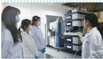
超快速液相色谱-高分辨串联质谱联用仪(Liquid Chromatography/Mass Spectrometer (LC-MS)),是临沂大学在2017年6月以300万元价格购入型号为Q-Exactive Focus的专为常规分析应用而设计,在同一系统中同时实现准确可靠的定性和定量分析的仪器。目前存放于科技大楼,由化学化工学院负责管理。Q-ExactiveTM Focus专注于小分子分析,它使用的与Q-Exactive完全相同的四级杆和Orbitrap技术,确保了系统的稳定运行和超高的分析性能,帮助所有实验室完成各种应用领域的常规分析。仪器主要应用于食品安全、药物代谢、法医毒理和小分子药物检测、结构解析以及杂质分析,使更多实验室也能拥有高分辨检测的能力。
